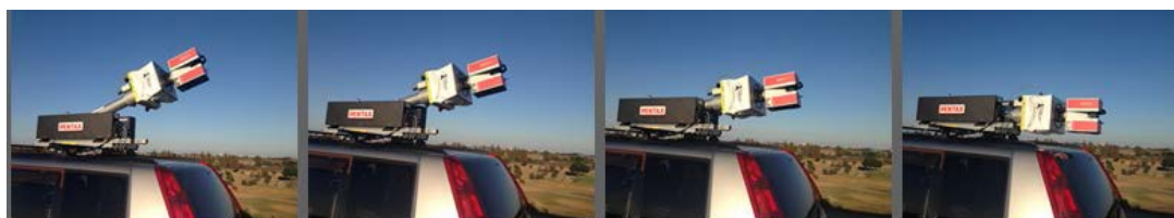
図 2.3-2 3D レーザスキャナの昇降図
