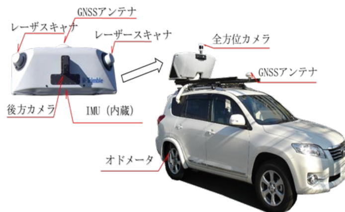
図 1-2 MMS 測量システムと搭載するセンサ例
