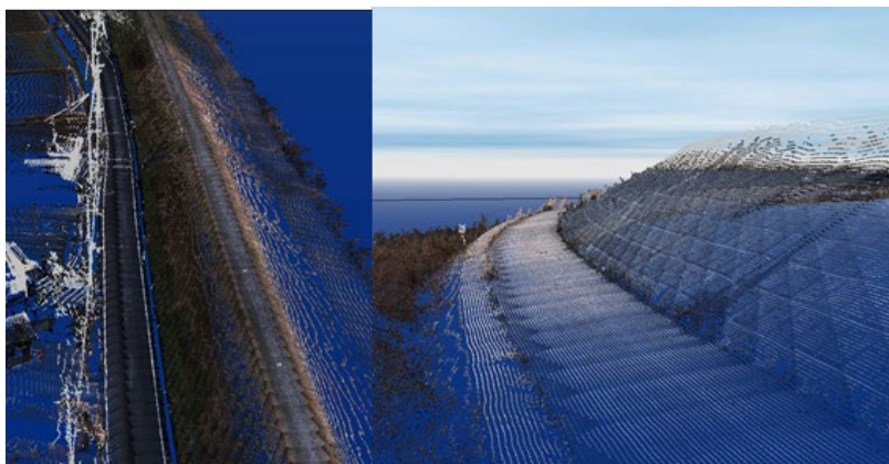
図 3.1-8 点群によって再現した堤防
