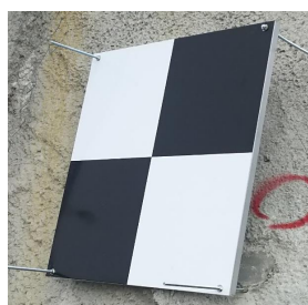
図 -2.10 ターゲット (1 辺が 0.7m の板)
