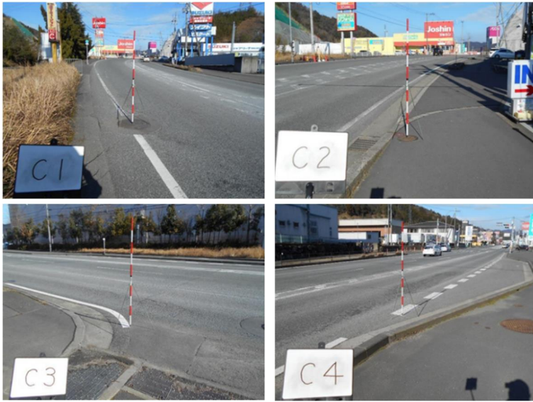
図- 2.13 道路上に設置した調整用基準点（C）4点
