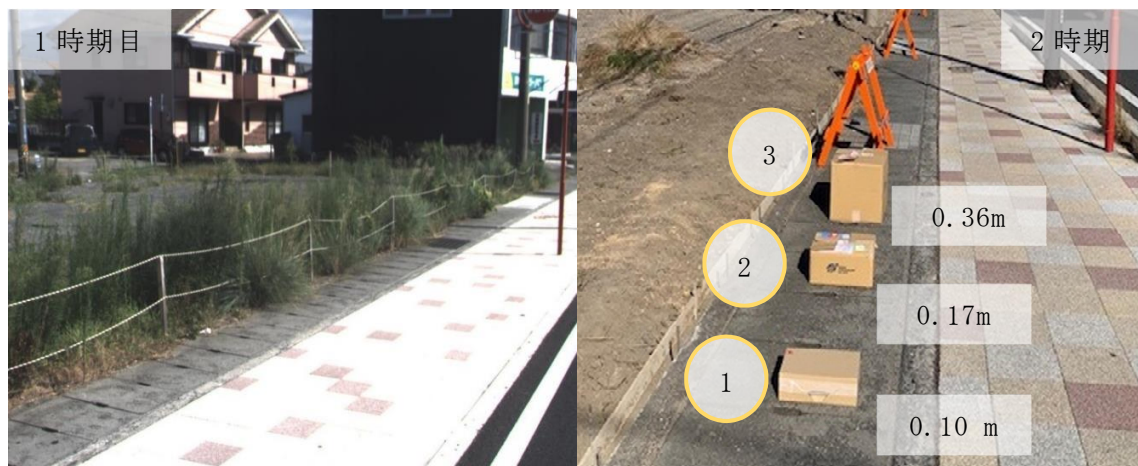
図-5.20：道路周辺に設置した段ボールの様子，段ボールの大きさ（縦×横×高さ） （一番手前の段ボール1：0.30×0.20×0.10，真ん中の段ボール2：0.33×0.27×0.17， 一番奥の段ボール3：0.36×0.33×0.36），単位はm
