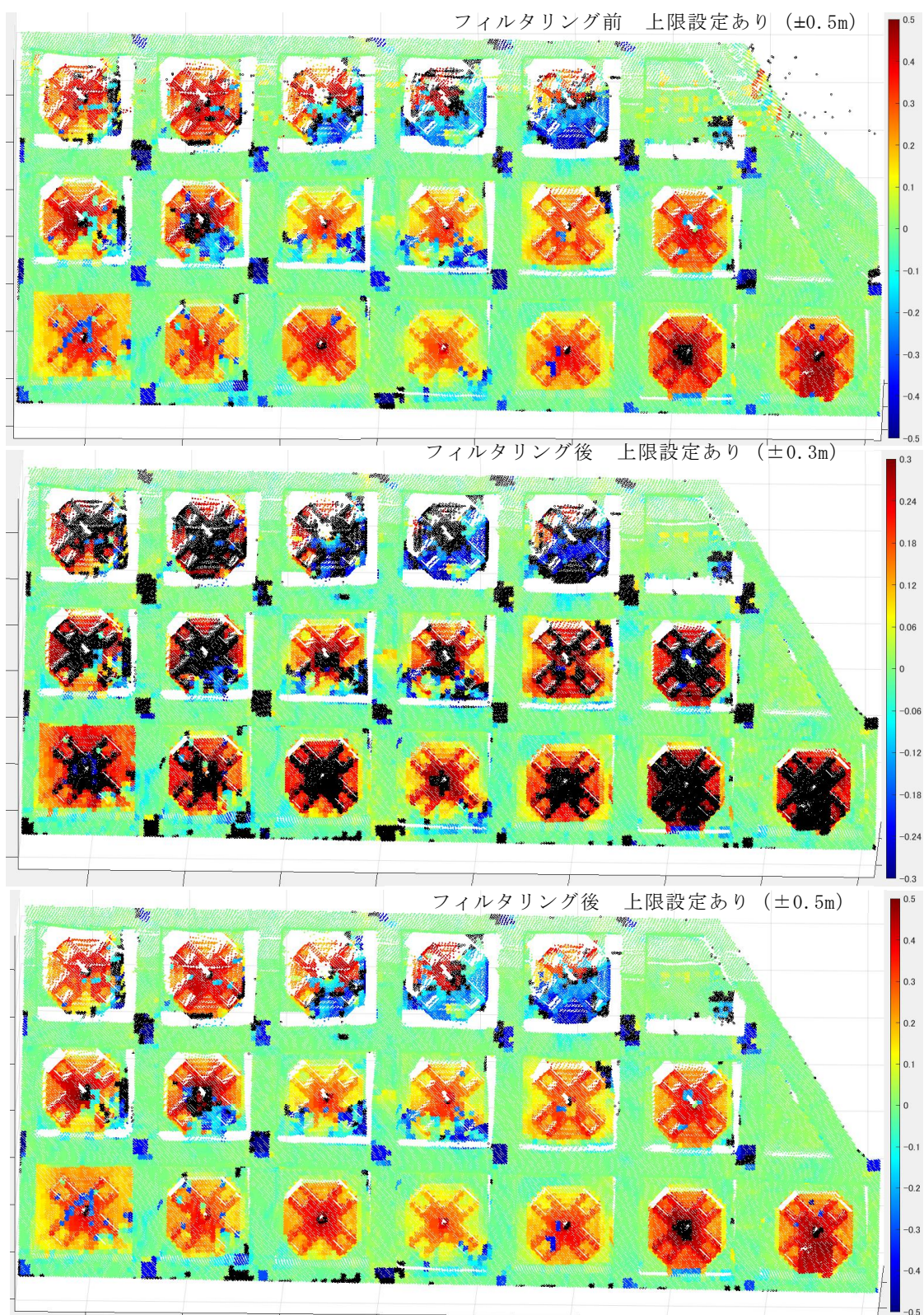
図-5.17 のり枠内アンカー新設部の解析結果（単位はm）。フィルタリング前後と上限下限の変更を行なっている。上限は \pm 0.3\text{ m} 、 \pm 0.5\text{ m} の設定で2回行なっている。
