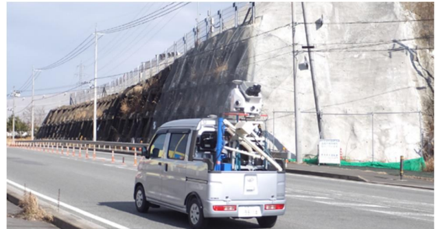
図- 1.7 MMS を用いてのり面点群を取得している様子
