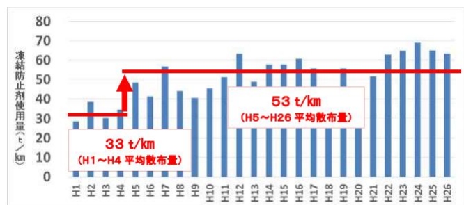
図- 1.3 NEXCO 3 会社が管理する高速道路（積雪寒冷地）における凍結防止剤散布状況．（出典：令和 3 年 1 月 20 日「社会資本整備審議会 道路分科会 第 47 回国土幹線道路部会」資料 4 より）
