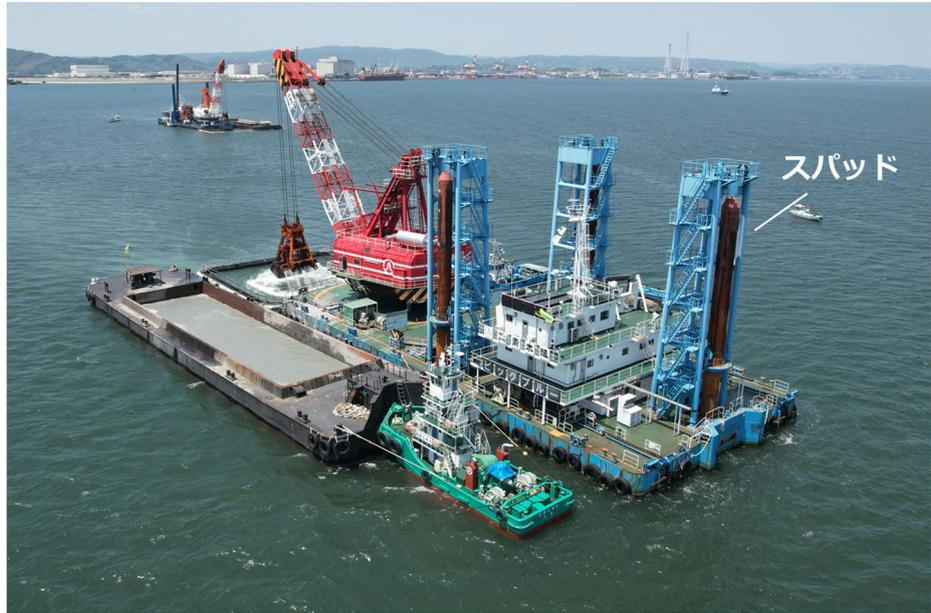
図-3.42 実際の浚渫工事に使用した浚渫船
