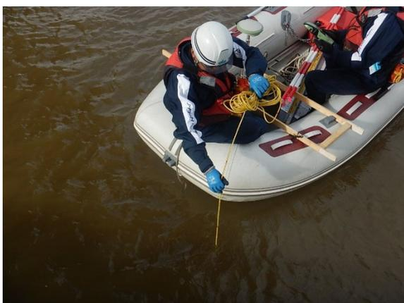
図-4.50 レッド測量状況
