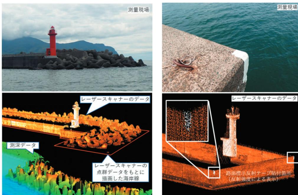
図-2.7 左：消波ブロックの海岸線の点群データ，右：点群の反射強度差による表示
