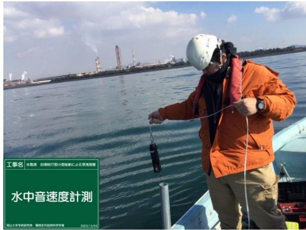
図-3.26 水中音速度計測の様子
