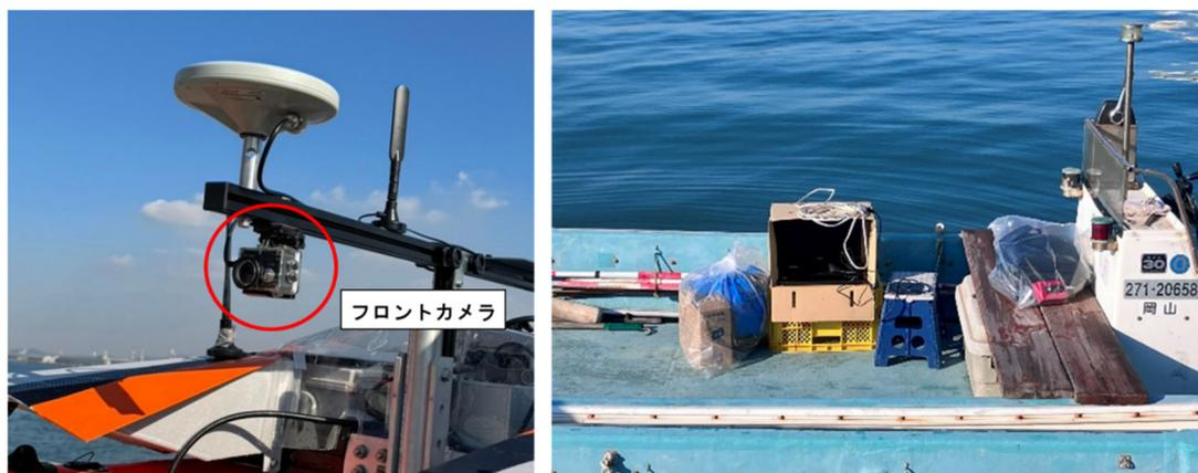
図-3.25 左：USV 船首に搭載のフロントカメラ，右：Web 会議配信用の現地 PC
