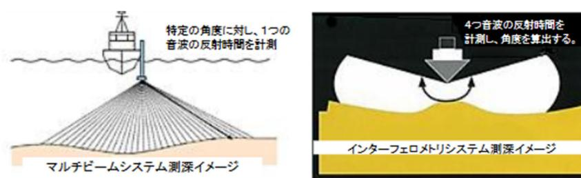
図-3.1 スワス測深システム（左：マルチビーム，右：インターフェロメトリ）
