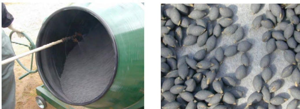
図 2.4-3 鉄コーティング作業（上）と鉄コーティングされた種子（下）
