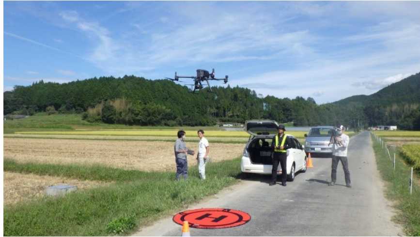
図 1.1-6 写真測量で使用されている UAV 機材
