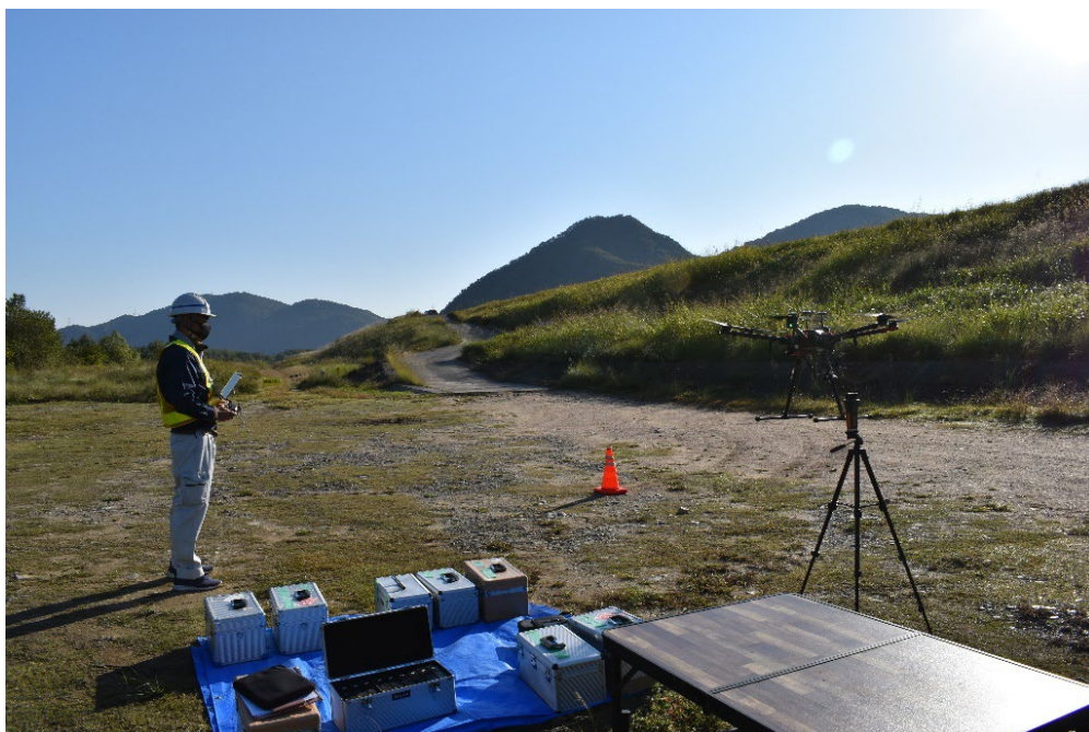
図 2.5-2 河川の現場で使用されるグリーンレーザ搭載 UAV 計測
