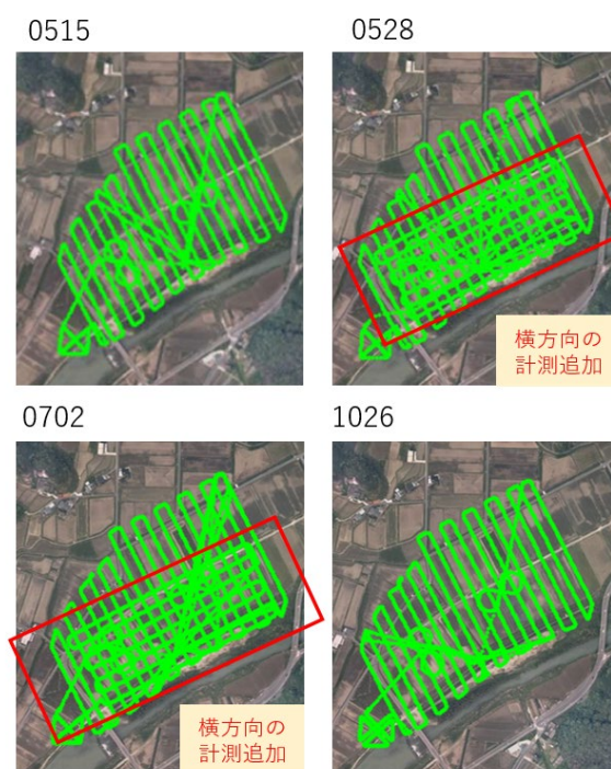
図 4.10-2 各計測における計測の飛行コース
