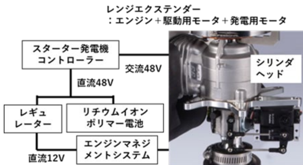
図 5.2-2 ガソリンエンジンを使った発電機システムの概要
