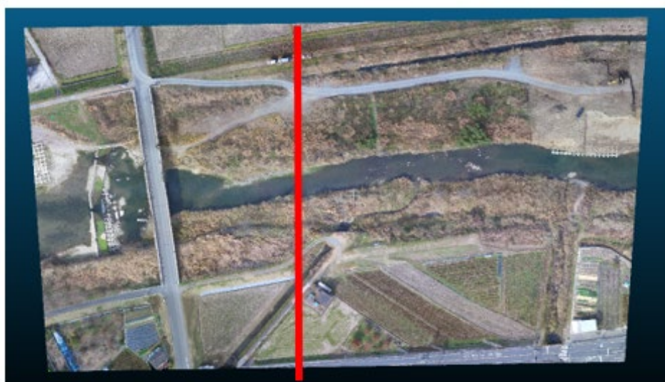
図 4.3-2 クラウドコンペアでの三次元再現と断面図の位置
