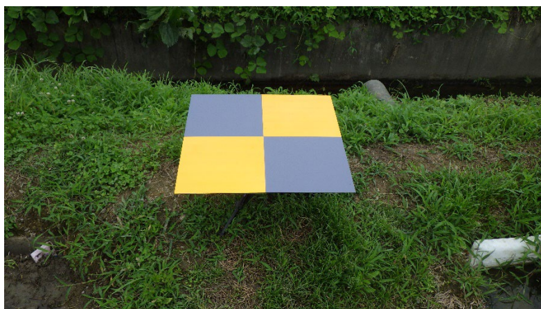
図 4.2-3 設置した対空標識の例
