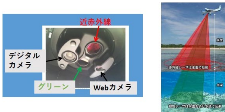
図 3.1-2 ALB に搭載されているレーザ測距装置と計測状況
