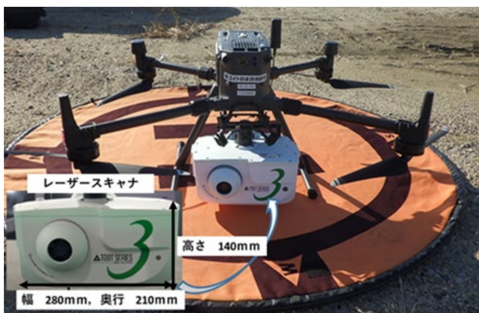
図 5.1-1 グリーンレーザ照射スキャナ搭載ドローンの概観
