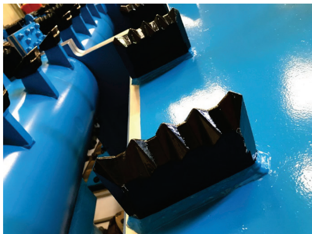
写真-5.7 支障物ビット
