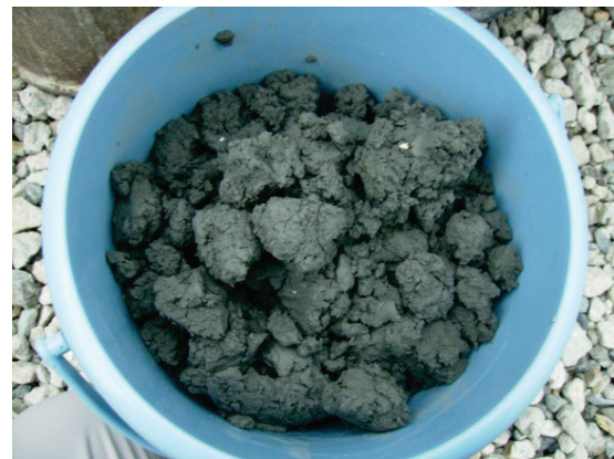
写真-2.7 消泡後の掘削土
