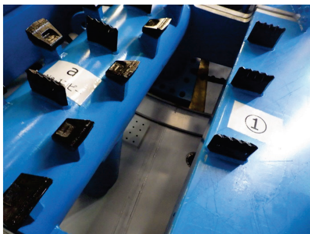
写真-5.6 カッターヘッドの面取り
