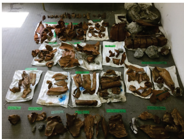
写真-5.8 切削・排出された支障物
