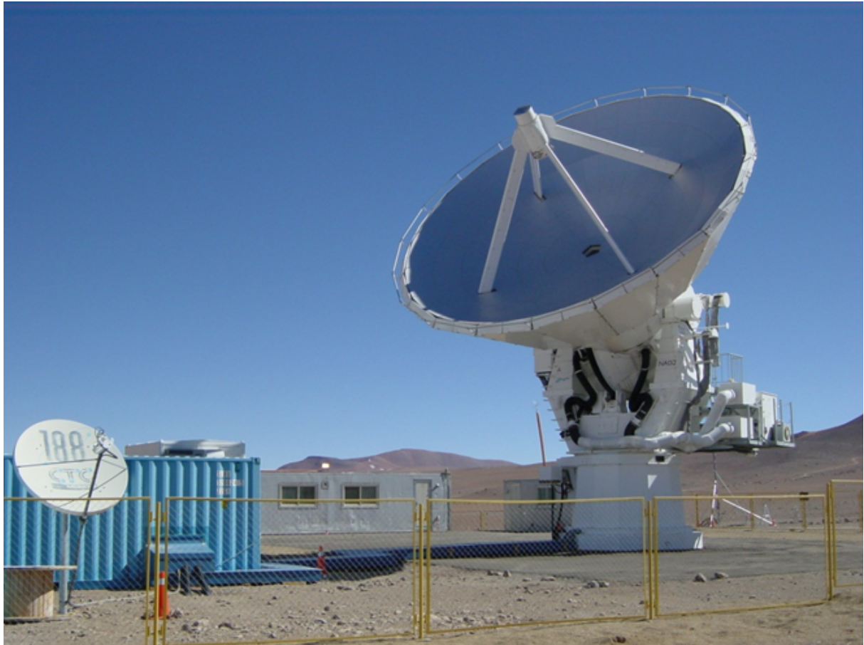
図 1.7: ASTE (Atacama Submillimeter Telescope Experiment) 望遠鏡。直径が 10m のサブミリ波天体望遠鏡で、南米チリのアタカマ砂漠 (標高 4,860m) に設置されている [11]。
