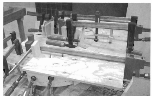
図14 クランプによる圧縮の状態
