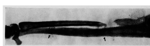
写真 4. 骨模型 (フェノライト試験片)
