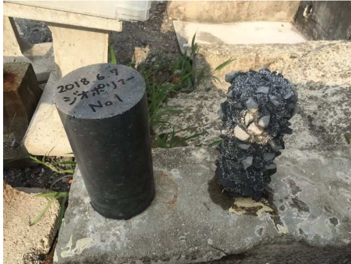
写真 5.4-2 56 日間 5%硫酸に浸漬した水ガラス 2 号を用いた GP コンクリート (左側 CS 使用, 右側 BFS 使用)
