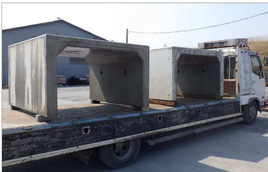
写真 4.3-2 散水湿潤養生終了後の製品
