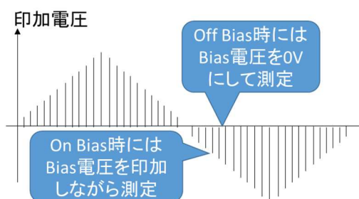
図 3-38 PFM の ON-バイアスと OFF-バイアスの違い。
