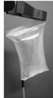
水を加熱すると袋は膨らむ。空気と同じようにクリップで止める。
