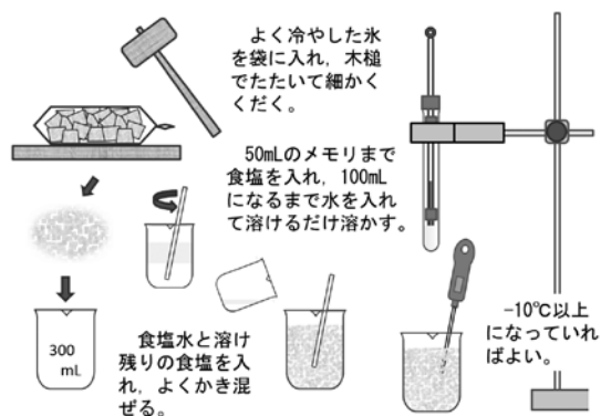
図9 試験管を冷やす氷と食塩水の準備
