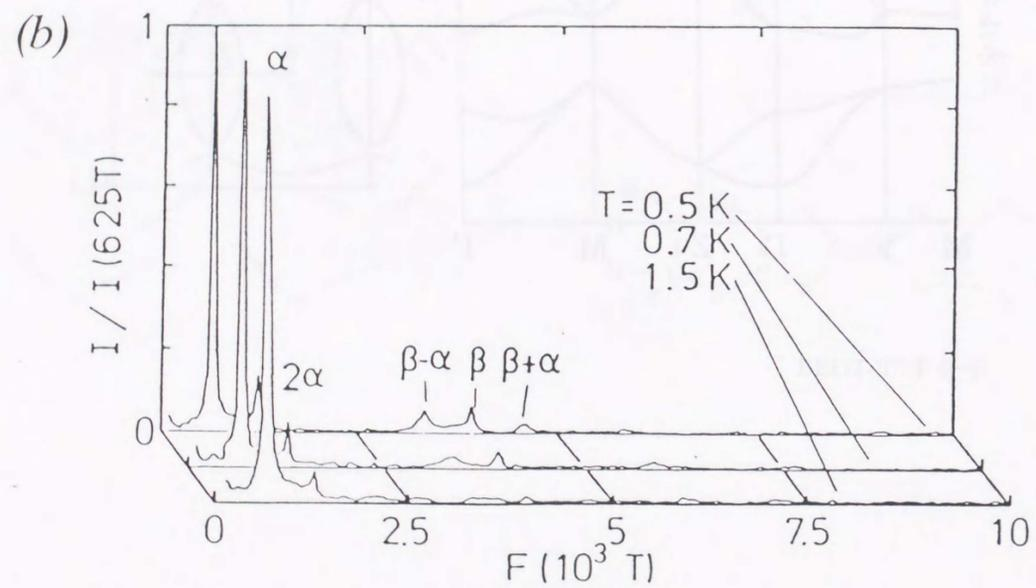
図 3.3(a), (b). (a)  $\kappa$ -(BEDT-TTF) $_2$ Cu(NCS) $_2$ の伝導面に垂直磁場を印加したときの磁気抵抗. (b) その Fourier 変換<sup>17)</sup>.
